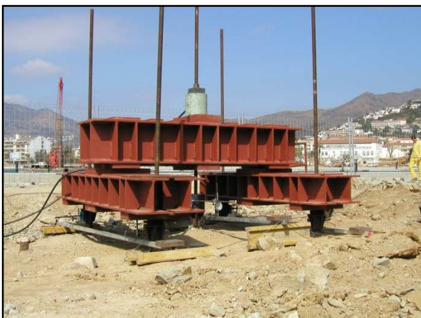
Figura 5: Ensayo a tracción de un micropilote instrumentado
