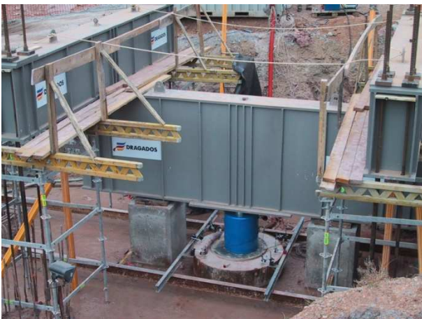
Figura 9: Ensayo de (carga lateral + momento) en un micropilote
