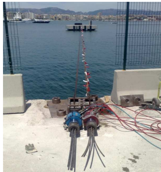
Figura 10: Ensayo de (carga lateral + momento) en un duque de Alba con pilotes
