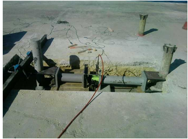
Figura 8: Ensayo de carga lateral de un micropilote
