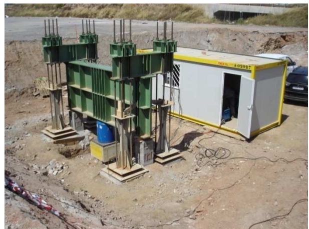
Figura 12: Ensayo de compresión de un pilote (850 T)
