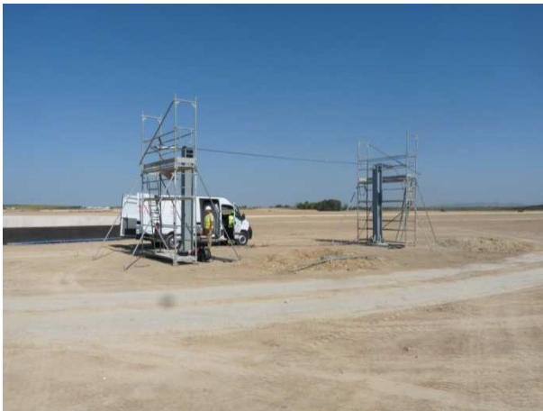
Figura 9: Ensayo de (carga lateral + momento) en un micropilote
